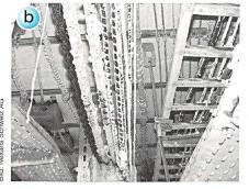
Bild 2 Der Systemtest E30 – Bilder aus dem Brandofen nach DIN 4102-12
