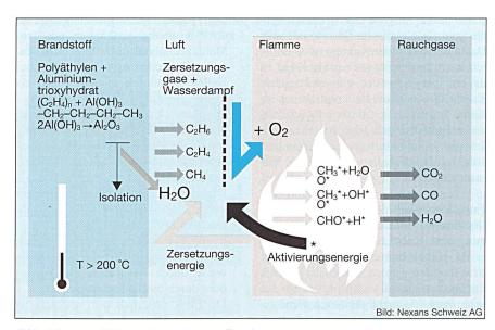
Bild 1 Schema der Wirkungsweise von Kunststoffzugaben
