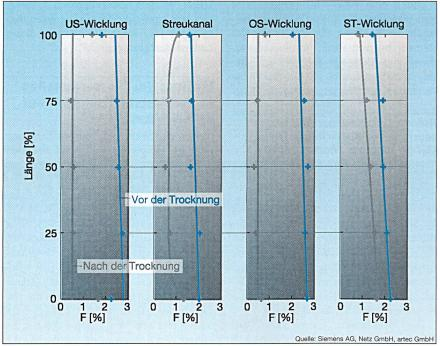
Bild 3 Verteilung des Wassergehaltes in der Feststoffisolation des Schenkels W vor und des Schenkels U nach der Aktivteiltrocknung
