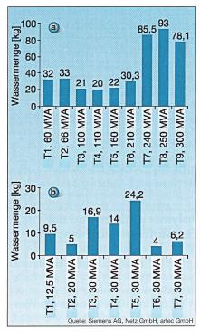
Bild 6 Wasserentzug bei der Trocknung von Transformatoren
