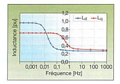
Figure 3 Essai à rotor bloqué Inductances opérationnelles  $L_{\rm d}$  et  $L_{\rm q}$  en fonction de la fréquence
