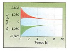
Figure 6 Courant d'excitation (conducteurs d'entrée et de sortie)
