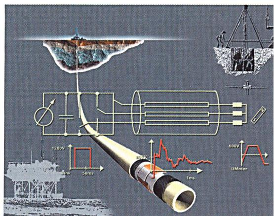
Bei konventioneller Tiefbohrtechnik wird eine Bohrspülung mit hohem Druck in die Tiefe gepumpt und so unter anderem auch hydraulische Energie zur Bohrlochsohle gebracht. Im Gegensatz dazu wird beim «Coiled Tubing» ein mit Grafitfaser verstärktes Thermoplastrohr verwendet, in dessen Wandung die elektrische Energieversorgung für den sich am Ende des Bohrstranges befindenden Elektromotor integriert ist (siehe auch Beitrag auf Seite 32).
