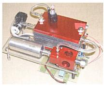
Gesamtsystem 20-Watt-PEM-Brennstoffzelle Système complet de la pile à combustible PEM de 20 W
