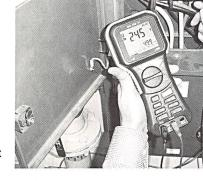
Mit dem ISO plus M von LEM können bis zu 350 Isolationsmessungen abgespeichert werden.
