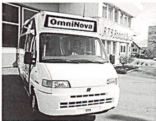
Testbus fährt dank Elektromotor und Superkondensator abgasfrei durch die Luzerner Innenstadt (Bild Gian Vaitl).
