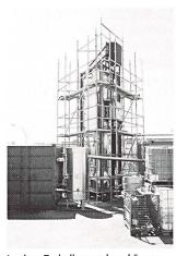
In einer Technikumsanlage können bereits 100 kg Altfett pro Stunde zu Brennstoff aufbereitet werden (Werkbild GMK).
