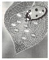
Der Einsatz von LED-Systemen bringt viele Vorteile für Lichtplaner und Verbraucher. LEDs erlauben durch den Aufbau von flexiblen Lichtmodulen vielseitige Einsatzmöglichkeiten. Farbige LED leben bis zu 100 000 Stunden, d.h. mehr als 10 Jahre ununterbrochenes Licht. Weisse LED haben eine Lebensdauer von bis zu 20 000 Stunden, also mehr als zwei Jahre (Bild Siemens).
