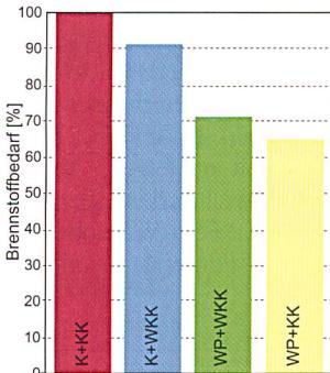
**Wärme und Strom aus Brennstoffen:** Unter Schweizer Verhältnissen ist die Kombination von Wärmepumpen (WP) und Kombikraftwerken (KK) am effizientesten. K = Heizkessel, WKK = Wärme-Kraft-Kopplungsanlagen.
