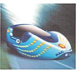
Das Sparmobil PACCar wird mit Brennstoffzellen angetrieben
