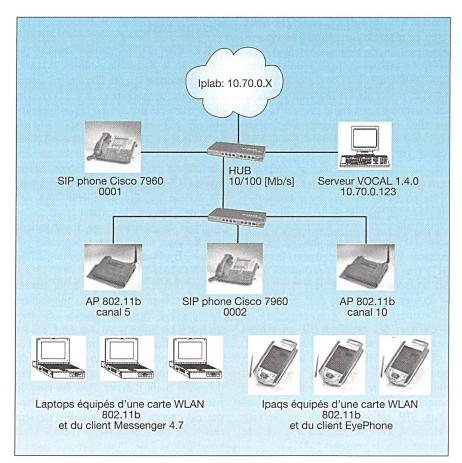
Figure 2 Architecture du réseau test
