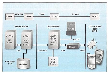
Bild 2 Der Vorgang des Datenauslesens mit MDE2
