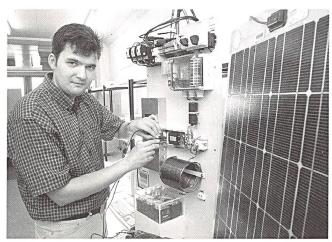
Doppelschichtkondensatoren gleichen schwankendes Energieangebot bei Sonnenenergie aus (Bild TU Chemnitz).
