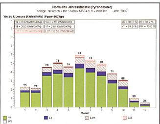
Bild 4 Normierte Jahresstatistik 2002 der a-Si-Tandem-Anlage Newtech 2 mit BP Solarex MST43LV (Spezifischer Jahres-Energieertrag 2002: 964 kWh/kW<sub>n</sub>).
