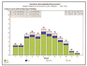
Bild 5 Normierte Jahresstatistik 2002 der a-Si-Tripel-Anlage Newtech 3 mit Unisolar US-64 (Spezifischer Jahres-Energieertrag 2002: 1033 kWh/kW<sub>p</sub>).
