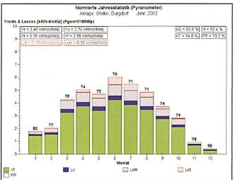
Bild 6 Normierte Jahresstatistik 2002 einer Anlage mit monokristallinen Modulen (Spezifischer Jahres-Energieertrag 2002: 931 kWh/kW<sub>p</sub>).
