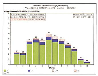
Bild 3 Normierte Jahresstatistik 2002 der CIS-Anlage Newtech 1 mit Siemens ST40 (Spezifischer Jahres-Energieertrag 2002: 1091 kWh/kW<sub>n</sub>).
