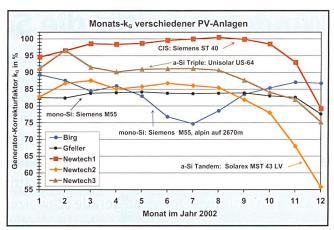
Bild 8 Monats-Generator-Korrekturfaktor  $k_G$  der drei Newtech-Anlagen im Vergleich zu zwei Anlagen mit mono-c-Si (alpine Anlage mit  $\beta$  = 90° auf 2670 m).
