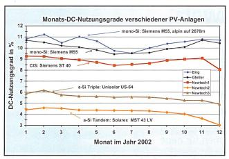
Bild 7 Monats-DC-Nutzungsgrad der drei Newtech-Anlagen im Vergleich zu zwei Anlagen mit mono-c-Si (alpine Anlage mit  $\beta$  = 90° auf 2670 m).
