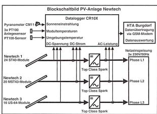
Bild 2 Blockschaltbild der PV-Anlage Newtech mit Messeinrichtung.
