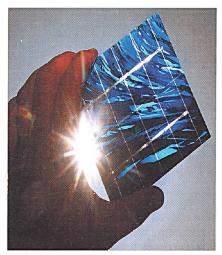
Durch die Energie des Sonnenlichts werden in der Solarzelle laufend Elektronen aus ihren Plätzen in den Atomen herausgeschlagen. Dank der dabei vom Licht übernommenen Energie sind diese Elektronen nun innerhalb der Zelle frei beweglich, unterliegen aber der Anziehung durch die von ihnen «verlassenen» und dadurch positiv geladenen Atome.
