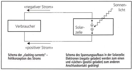
Bild 3 Die von der Standarderklärung geförderte Fehlauffassung, wonach in beiden Leitungsdrähten alle Ladungsträger ausschliesslich von der Solarzelle zum Verbraucher fliessen.
