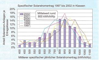
Bild 3 Die spezifischen Jahreserträge der Solarstromanlagen im Jahre 2002 (Balkendiagramm) in Kilowattstunden pro installiertes Kilowatt (kWh/kW<sub>p</sub>), aufgeteilt in 50-kWh/kW<sub>p</sub>-Klassen. Im Vergleich dazu die Werte der Vorjahre. Der Mittelwert liegt wieder ähnlich bei rund 800 kWh/kW<sub>p</sub>.
