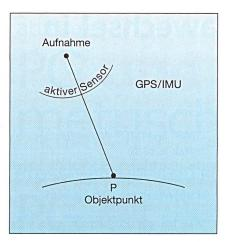
Bild 2 Grundmuster des Laser-Scannings bzw. der neuzeitlichen Photogrammetrie
