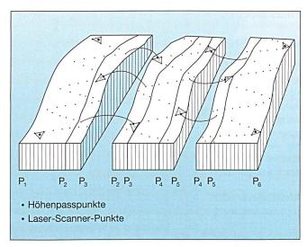
Bild 3 Simultane Höheneinpassung von überlappenden Laser-Scanner-Streifen in das globale Koordinatensystem. P.: Geradlinige Geländeprofile
