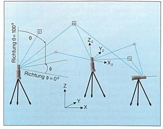
Bild 4 Blockausgleichung mit «unabhängigen Modellen»
