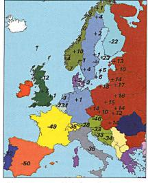
Bild 5 Höhenunterschiede der nationalen Höhensysteme zum europäischen Höhensystem
