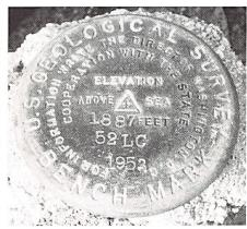
Benchmark (Landmarke, Triangulationspunkt) des US Geological Survey (Bild NASA).
