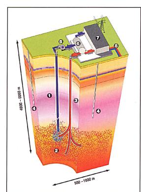
Bild 3 Funktionsprinzip einer geothermischen Deep-Heat-Mining-Anlage. (Quelle: Häring GeoProject, Steinmaur)
