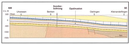
Bild 6 Geologisches Profil durch das Untersuchungsgebiet Zürcher Weinland mit der Bohrung Benken.
