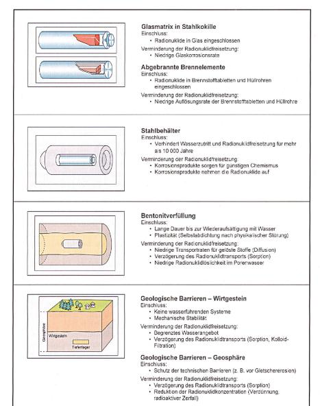
Bild 11 Das System der mehrfachen Sicherheitsbarrieren für abgebrannte Brennelemente und verglaste hochaktive Abfälle in einem geologischen Tiefenlager.
