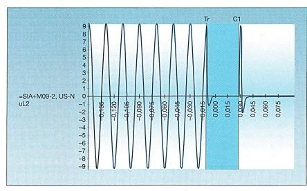
Bild 8 11-kV-Leistungsschalter mit Rückzündung
