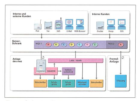
Bild 2 Systemaufbau des ewz-Netzqualitätssystems
