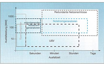
Bild 6 Übersicht der Massnahmen zur Erhöhung der Versorgungssicherheit
