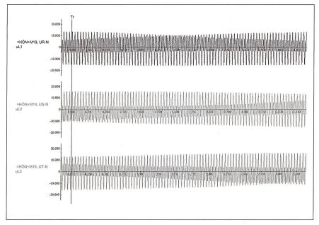
Bild 7 Ferroresonanz eines 11-kV-Spannungswandlers
