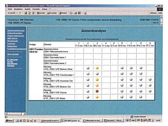
Bild 3 Aufzeichnung eines 2-poligen Kurzschlusses: Zustandsanalyse pro Fehlersegment
