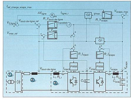
Figure 4 Diagramme structurel du réglage de la sous-station à stockage
