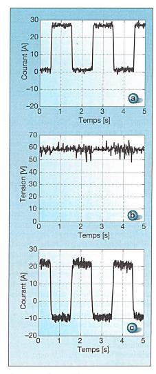
Figure 7 Résultats expérimentaux avec compensation active et réglage de tension
