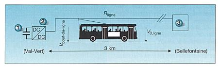
Figure 1 Système d'alimentation avec sous-station à stockage pour compenser les chutes de tension en bout de ligne
