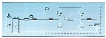
Figure 3 Schéma de principe de la sous-station et du convertisseur statique
