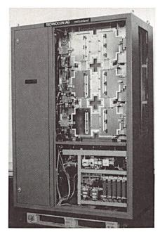
Bild 5 800-kW-Umrichterschrank
