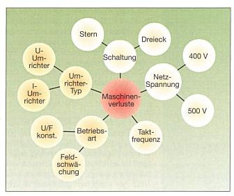
Bild 10 Einflussfaktoren auf die Maschinenverluste
