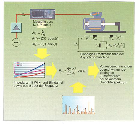
Bild 7 Ablaufschema zur Vorausberechnung der Oberschwingungsverluste
