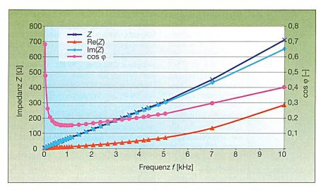
Bild 8 Messwerte für Impedanz und cos φ an einer 4-poligen Maschine der Baugrösse 132 S
