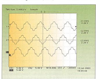
Bild 5 Spannungsverlauf 3-phasig am Ausgang der Verstärker
