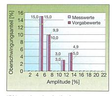
Bild 6 Fourieranalyse des Signals
