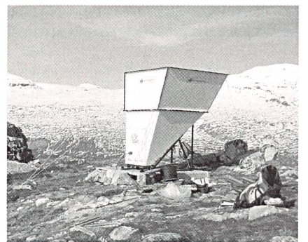
Mit dem Sodar wird die Windgeschwindigkeit ab zirka 20 bis 150 Meter Höhe über Grund bestimmt.
