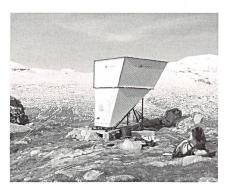
Mit dem Sodar wird die Windgeschwindigkeit ab zirka 20 bis 150 Meter Höhe über Grund bestimmt.
