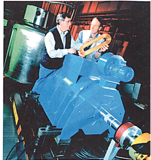
Elektromotor mit eiskaltem Herz: In Erlangen betreibt Siemens eine Synchronmaschine mit einer supraleitenden Läuferwicklung. Die Stromdichte ist etwa zehnmal so gross wie bei einer Kupferspule.
