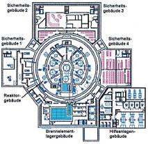
Bild 3 Grundriss des EPR.
