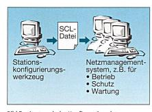
Bild 7 Austausch der Konfigurationsdaten
