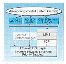
Bild 5 Abbildung des Anwendungsmodells auf die Kommunikation
