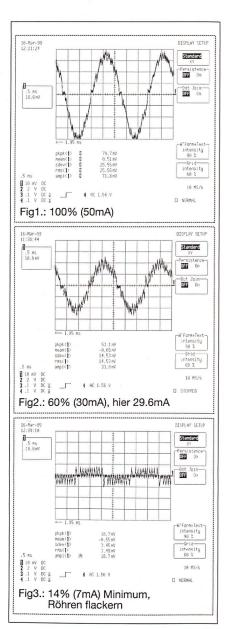
Bild 5 Sekundärstrom bei unterschiedlicher Helligkeit
