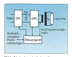
Bild 1 Prinzipschema des Speisegerätes
