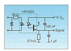
Bild 3 Schema Erdstrommessung
