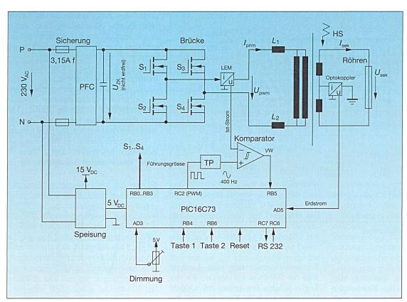
Bild 2 Blockdiagramm des Speisegerätes
