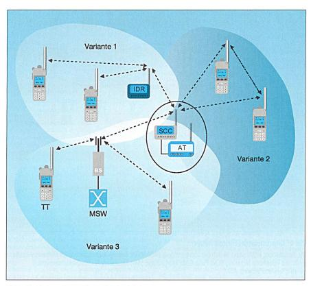
Bild 2 Verbindung eines analogen Kanals mit Polycom
