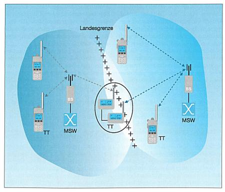
Bild 3 Verbindung verschiedener Tetrapol-Netze
