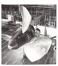
Rohrturbinenlaufrad (Bild VA Tech).
