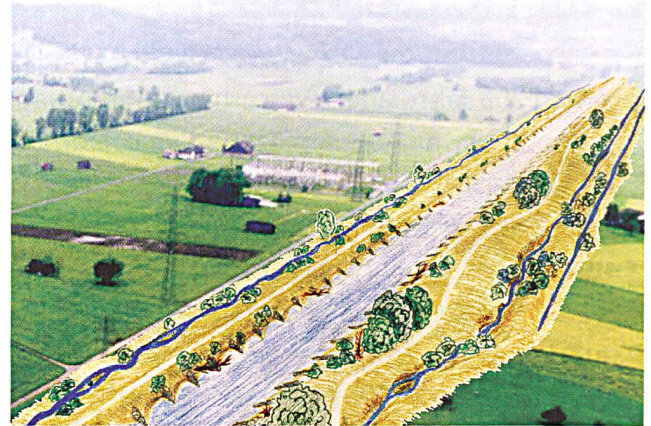
Giessen-Grynau heute/Giessen-Grynau Zukunft: Zwischen Giessen und Grynau wird der Linthkanal mit seinen Hintergräben umfassend umgestaltet. Dadurch wird einerseits der Hochwasserschutz wieder gewährleistet, andererseits eine weit reichende ökologische Aufwertung erzielt. (Grafik: habitat)
