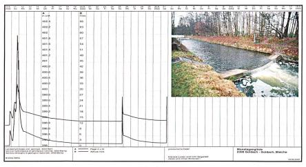
Bild 5 40-Tage-Grafik mit drei Hochwasserphasen bei Goldach (SG). Am 31. August 2002 wurde die Messstation überflutet und beschädigt (Bildmitte).
