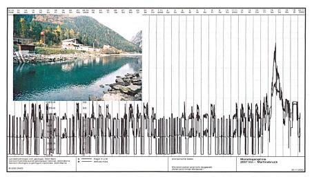
Bild 4 Auf dem Datenblatt lässt sich zum Beispiel eine 40-Tage-Grafik ausdrucken. Hier die Situation am Inn bei Martinsbruck im Unterengadin nach dem Hochwasser vom 16. November 2002 (rechts im Bild). Bis zu diesem Datum ist ein normaler Pegel und Abfluss mit regelmässigem Turbinierbetrieb feststellbar.
