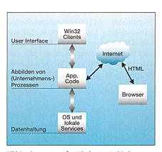
Bild 6 Components for Windows – Architekturmodell einer Windows DNA-Anwendung
