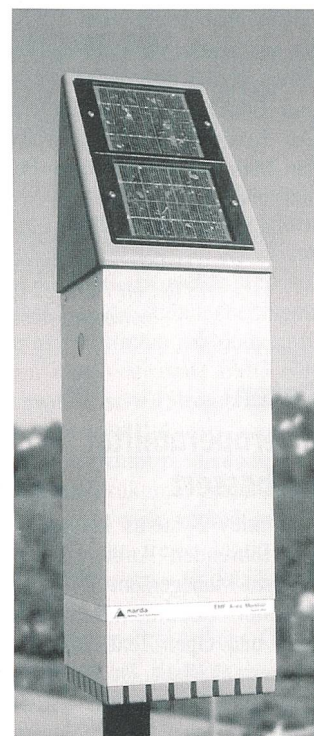
Permanente Überwachung mit dem Narda Area Monitor System 2600. Gut sichtbar sind die Solarzellen für die unabhängige Stromversorgung
