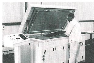
Südafrikanischer Arbeiter verschweisst einen PV-Panel (Bild nrel).
