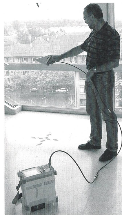
Bild 8 Frequenzselektive Messung mit externer Antenne und Spektrumanalysator
