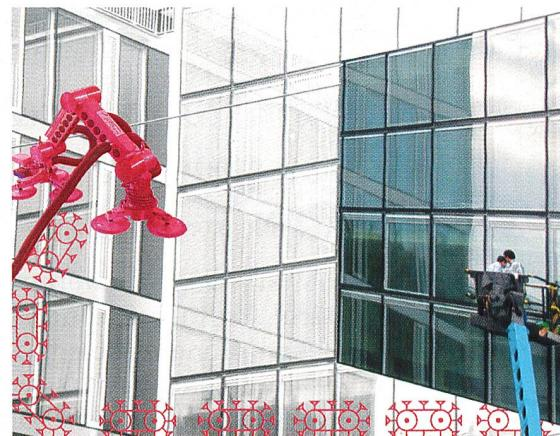
Reinigungs- und Inspektionsarbeiten an Gebäudefassaden von Hochhäusern werden trotz des hohen Gefahrenpotenzials für die Ausführenden und trotz hoher Kosten heute noch vorwiegend manuell ausgeführt. Als Alternativen bieten sich moderne Roboter an, die selbstständig an Fassaden klettern und die verschiedensten Arbeiten ausführen können (siehe auch Beitrag auf Seite 11).
