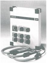
Lastflussanalysatoren Topas 1020/1040 von LEM mit aktualisierter Software
