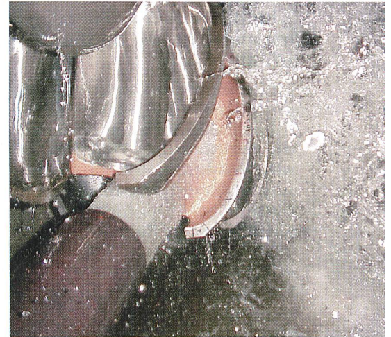
Bild 5 Vollbeaufschlagte korrigierte Schaufel im volldimensionalen Prüfstand.
