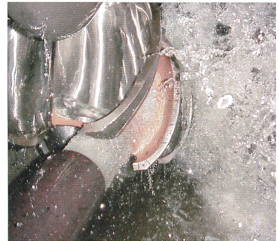
Bild 5 Vollbeaufschlagte korrigierte Schaufel im volldimensionalen Prüfstand.
