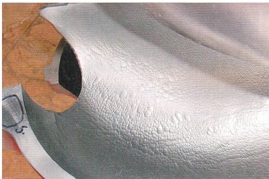
Bild 3 Ein weiterer Schadensmechanismus ist der Tropfenschlag. Dabei schlagen Wassertropfen, weil sie immer wieder auf die selbe Stelle im Laufwerk geschleudert werden, Dellen aus dem Laufwerk heraus. Die Ursache kann in einem divergierenden Strahl liegen, der an seiner Aussenseite «ausfranst», kann aber auch von einer stumpfen Mittelschneide herrühren, die bewirkt, dass der Strahl nach Aufprall auf der Schneide sich teilweise in Tropfen auflöst.
