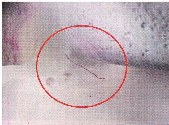
Bild 7 Rissentwicklung an der Becherwurzel.
