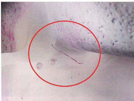
Bild 7 Rissentwicklung an der Becherwurzel.
