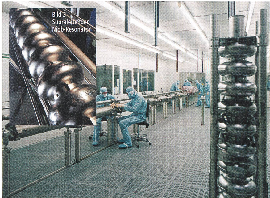
Bild 4 Arbeiten im Reinraum. Die supraleitenden Beschleunigungsstrukturen von TESLA bestehen aus reinstem Niob. Ihre Bearbeitung und Montage erfolgt in einem Reinraum, der fast eine Million Mal weniger Staubteilchen als normale Luft enthält und eine sehr saubere Verarbeitung ermöglicht.
