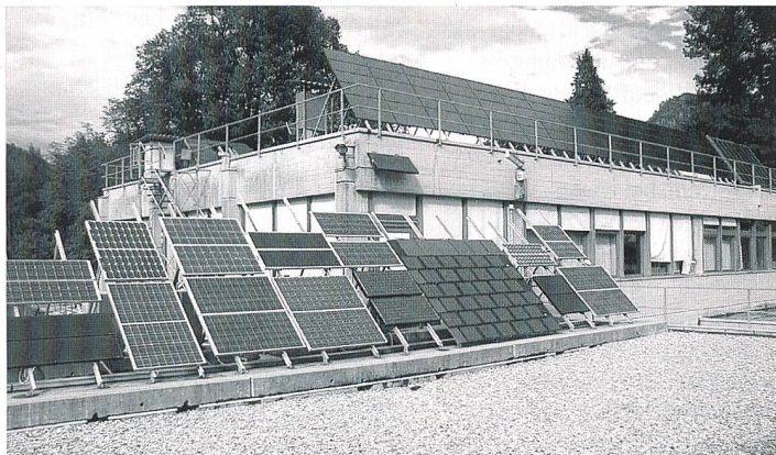
Teststand für Solarmodule am LEEE-TISO (Laboratorio di Energia, Ecologia ed Economia-Ticino Solare in Cannobbio (Bild: TISO).
