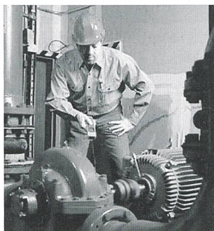
Ideal für Temperaturmessungen an rotierenden, spannungsführenden, heißen oder schwer zugänglichen Flächen: das Fluke 61
