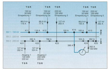
Bild 2 Lastflussplan der Freiluftschaltanlage
