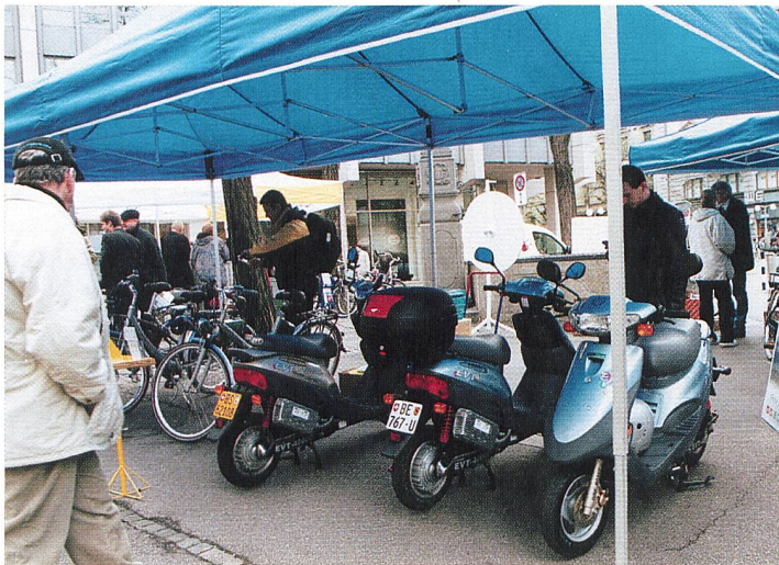
Bild 6 Der «E-Scooter EVT» wiegt 127 kg und erreicht 45 km/h (Motorleistung 1500 Watt, Reichweite bis 70 km, Batterie: Blei, Fr. 4600.-).
