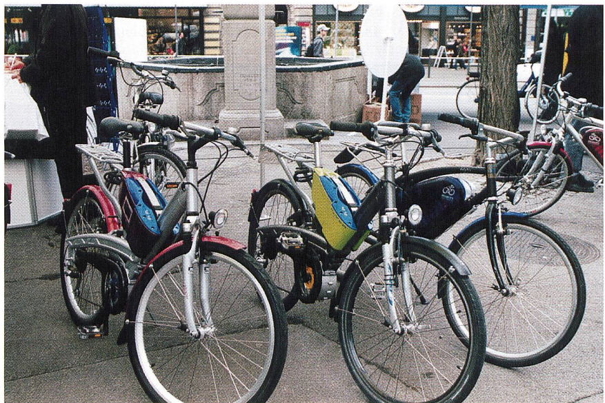
Bild 2 Die Powerbikes «Flyer» Modell 2002 und «Dolphin black powder» von Velocity. Das Getriebe, ein starker Motor und der Trittfrequenzsensor, verstärkt jeden Tritt in die Pedale, und die Fahrtgeschwindigkeit lässt sich so bequem um 15 km/h erhöhen (Bilder U. Wüthrich).
