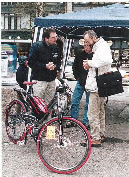
Bild 3 «Flyer 2002»: Die Akkubox ist abnehmbar und kann im Büro oder in der Wohnung geladen werden.
