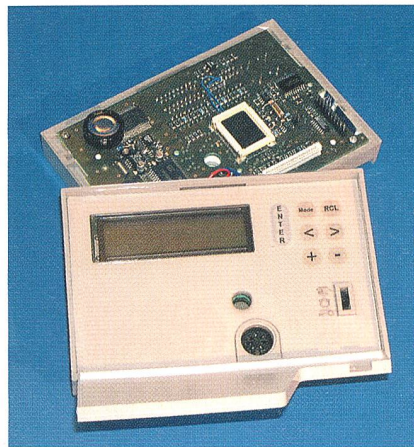
Bild 4 Der Neurobat-Prototyp basiert auf einem herkömmlichen Kompakt-Heizungsregler
