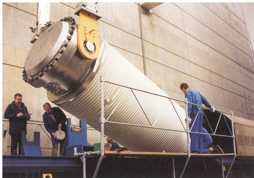
Transportbehälter für radio- aktive Brennelemente.
