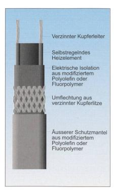
Bild 4 Selbstregelnde / selbstbegrenzende Heizleitung
