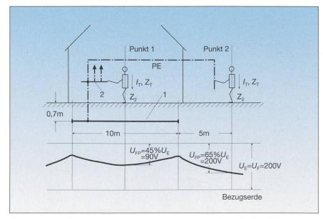
Bild 3 Spannungstrichter eines Fundamenterders innerhalb und ausserhalb eines Gebäudes. Fehlerspannung  $U_{\rm F}$  = 200 V und berührbare Teilfehlerspannungen  $U_{\rm FP}$
