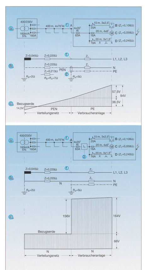
Bild 4 Ausschaltströme und Fehlerspannungen des PEN-Leiters in einer Verbraucheranlage mit einer Energieversorgung aus einem Freileitungsnetz
